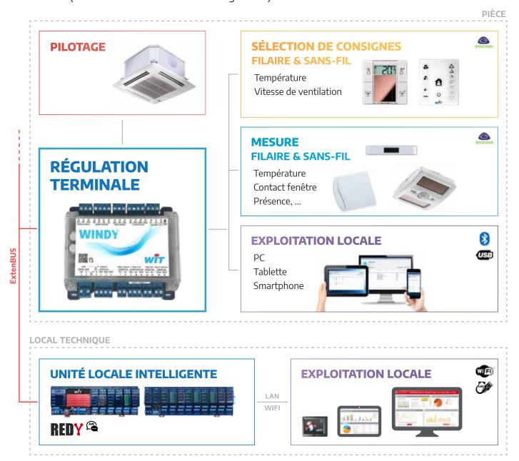
Il récupère les consignes de température et de vitesse de ventilation à travers le SmartSensor et grâce à sa large connectivité, il est capable de recevoir des informations sur une multitude de paramètres dans la pièce.
